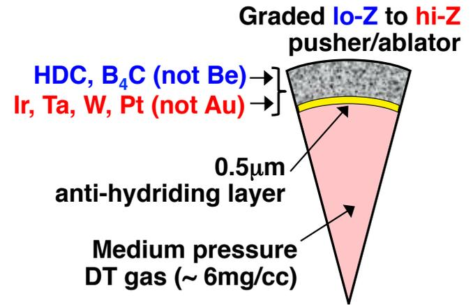
**Hi-Z metal-gas volumetric-ignition**
