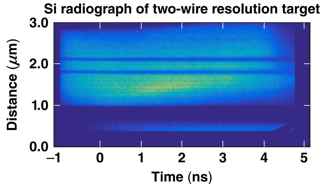
25- $\mu\text{m}$ -diam Ta wires
