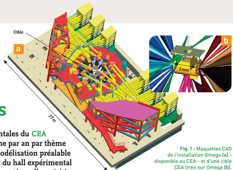
Fig. 1 : Maquettes CAO de l'installation Omega (a) - disponible au CEA - et d'une cible CEA tirée sur Omega (b). CAD models of Omega facility (a)- available at CEA - and of a CEA target (pre-shot) on Omega
