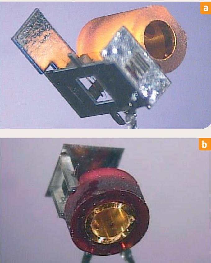
Fig. 1 : Édifices de cibles complets (cavités à gaz et sources de radiographie) assemblés au CEA - CESTA (voir article 19). (a) cavité Rugby - (b) demi-cavité
