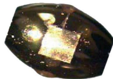
Fig. 2 : (b) La cavité rugby utilisée en 2009. Rugby hohlraum for 2009 campaign.
