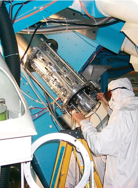
**Fig. 1 :** Installation du diagnostic DMX sur la chambre d'expériences d'Omega [novembre 1999].
